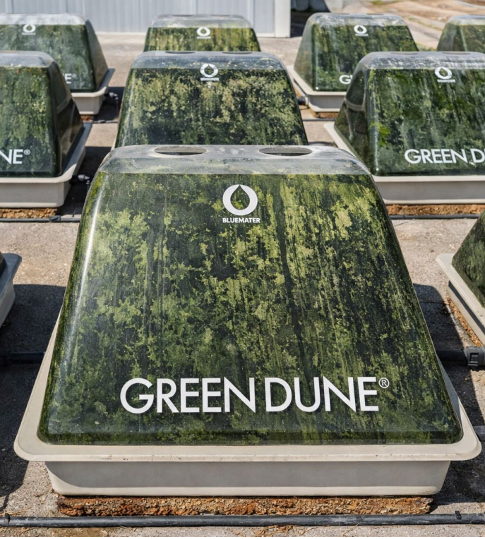
Şekil 3. Yunanistan'daki Thriasio Atıksu Arıtma Tesisi'nde kurulu GREEN DUNE® fotobiyoreaktörleri.
