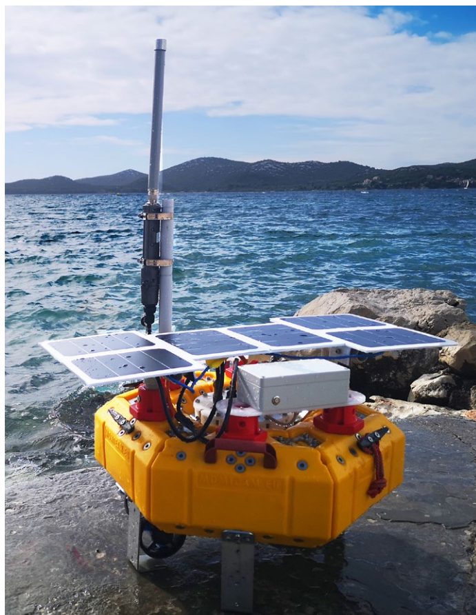
Εικόνα 4. Κόμβος παρακολούθησης για τη συλλογή δεδομένων νερού κατά τη διάρκεια μιας δοκιμής.
